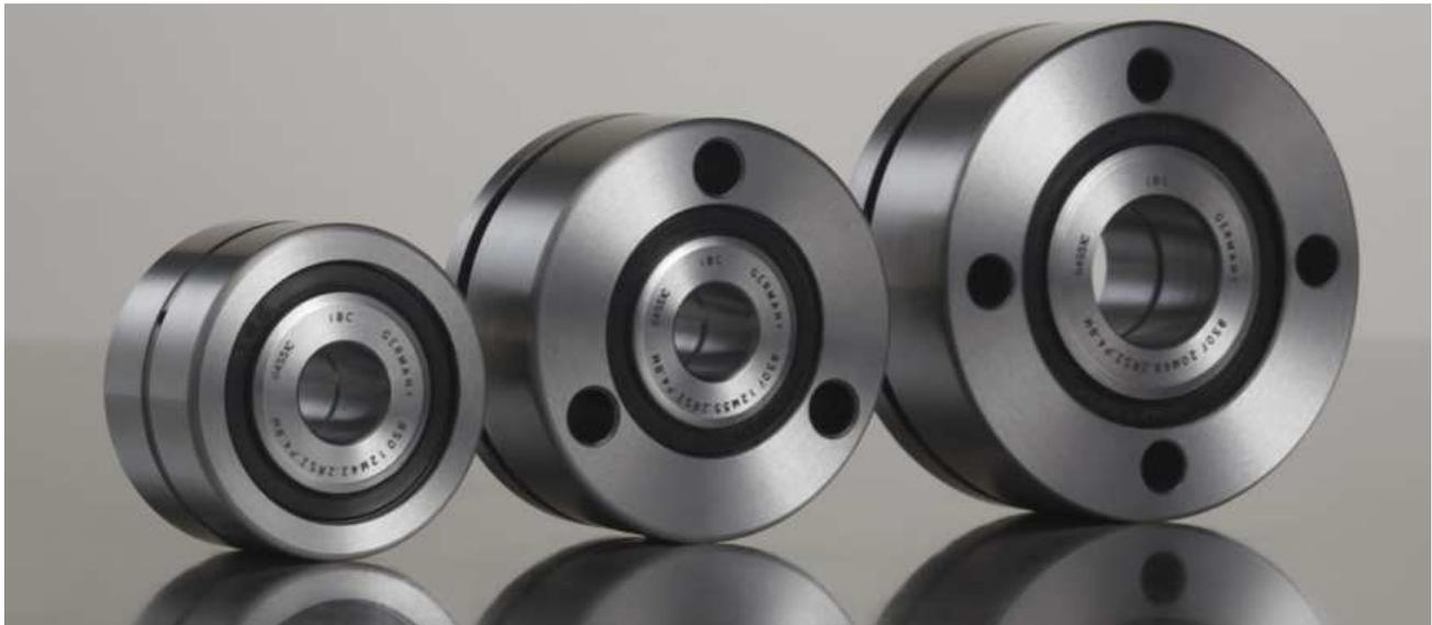
Zu unterscheiden ist zwischen anflanschbaren zweireihigen 60° - Axialschrägkugellagern (BSDF) und solchen, die nicht anflanschbar sind (BSD). Durchgangsbohrungen im Außenring ermöglichen bei BSDF Axial-Schrägkugellagern eine direkte Anflanschung an die Anschlusskonstruktion oder in eine radiale Fixierbohrung. Dies spart Zeit, da der Anpassaufwand entfällt.
